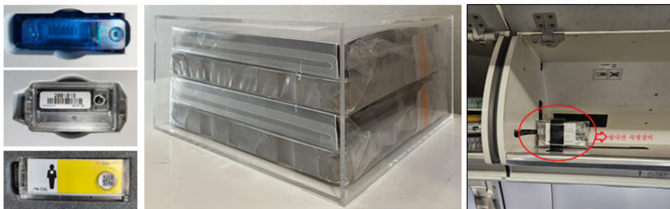
그림-4. 수동형 측정기 종류, 항공기 탑재를 위한 포장 및 항공기 탑재
