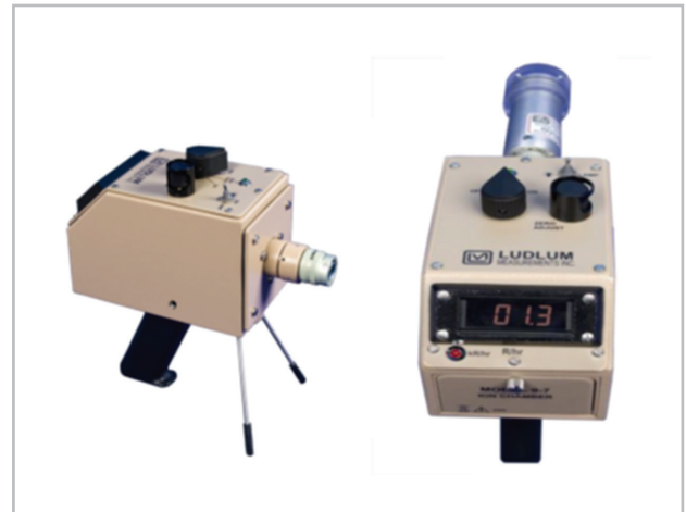
그림 11. 고선량률 측정용 이온챔버(Model 9-7 BH High Range Detector, ~200Sv/h)
