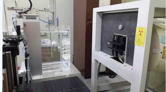
한국표준과학연구원에서 Co-60 감마선 조사기를 이용한 전리함의 물 흡수선량 교정 사진. 전리함이 교정을 위해 물 팬텀 내 5 cm 물 깊이에서 정렬되어 있다.
